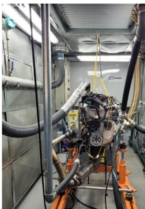
Figura 4: Motor protótipo modificado e instalado durante realização de testes (Fonte: Elaborada pelos autores)
