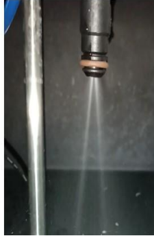
Figura 8: Medições experimentais de fluxo de massa estático e dinâmico de spray de etanol (Fonte: Elaborada pelos autores)
