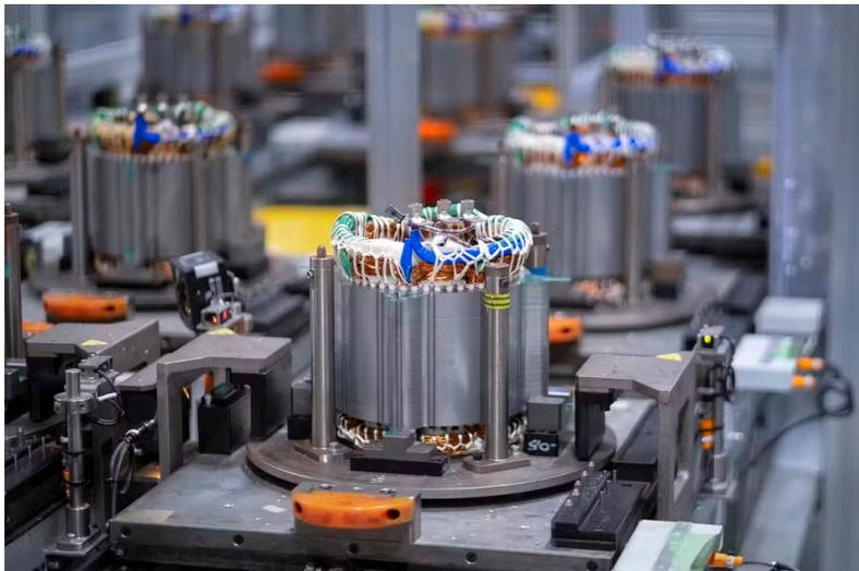
Linha de produção de motor elétrico da Renault em Cléon, França: estator tem fios de cobre enrolados no lugar de ímãs — Foto: Langephoto/Autoesporte
