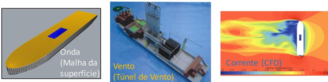
**Figura 2 – Modelos para determinar coeficientes de onda (esq.), vento (centro) e corrente (dir.)**
