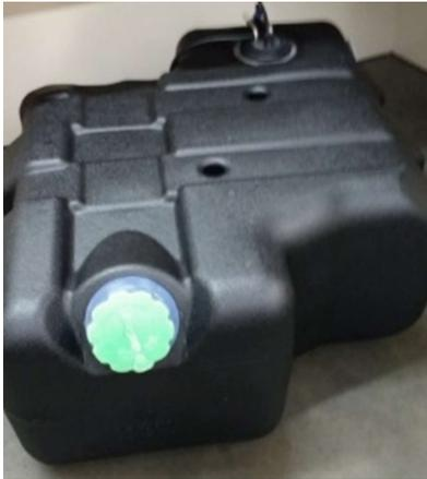
Fig. 14. Tanque de ARLA 32 de Polietileno de Alta Densidade Verde.
