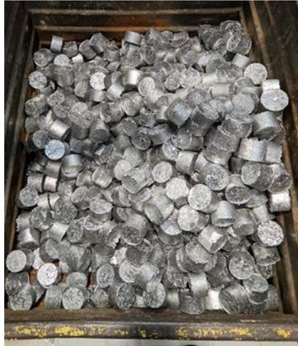
Figura 4 – Cavaco de alumínio briquetado
