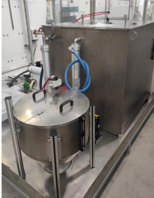
Figura 6 – Estação definitiva de tratamento e filtragem de óleo solúvel
