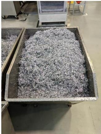
Figura 1- Detrito de usinagem (cavaco)
