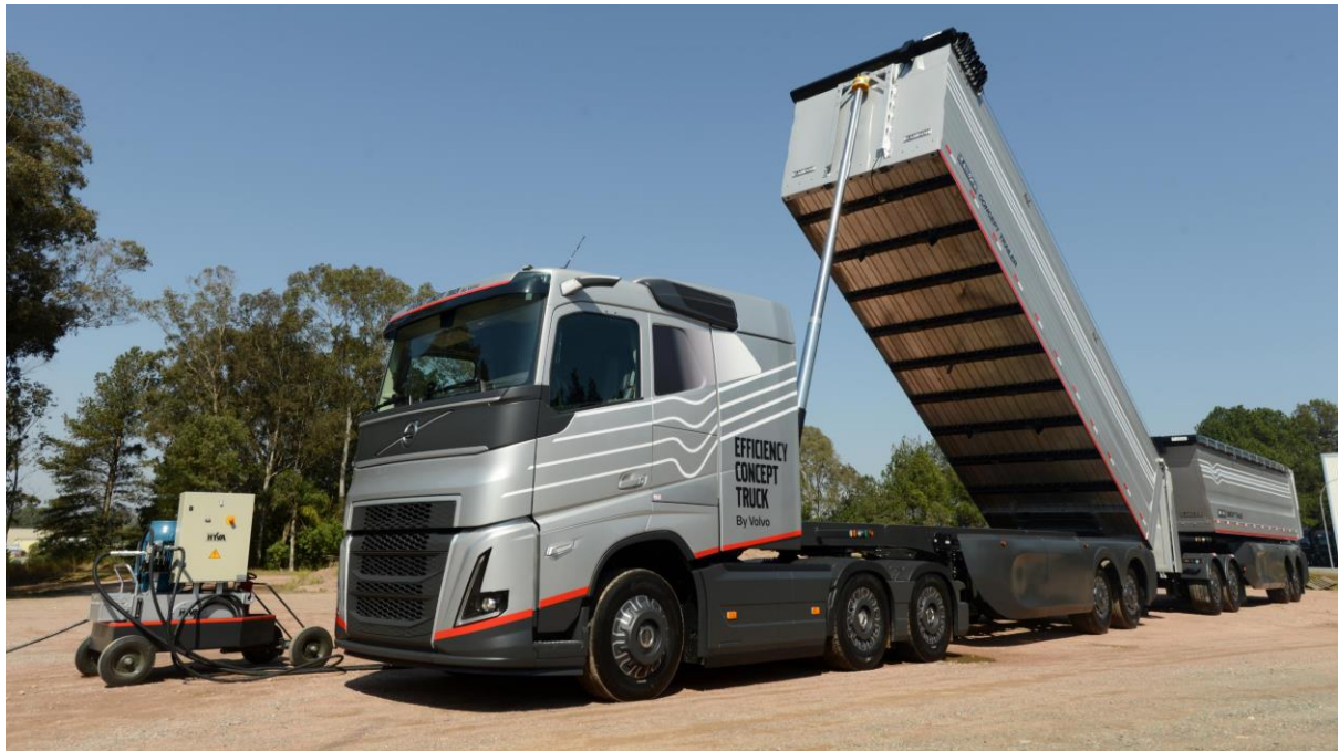
Figura 6 - Estação Hidráulica Externa em Ação
