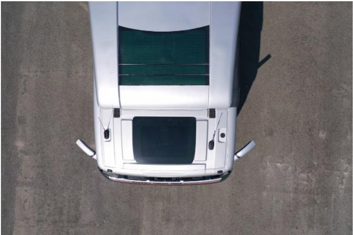
Figura 3 - Painel Foto Voltaico
