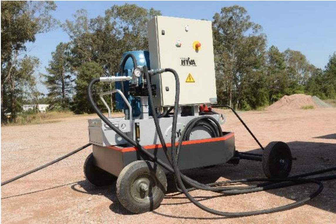
Figura 5 - Estação Hidráulica Externa
