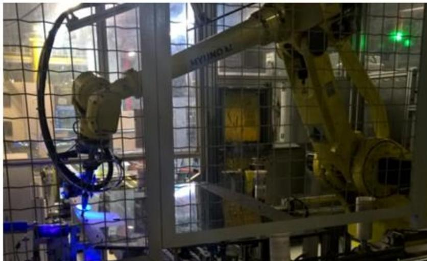
Figura 08 – Robô realizando a aplicação do primer nos vidros
