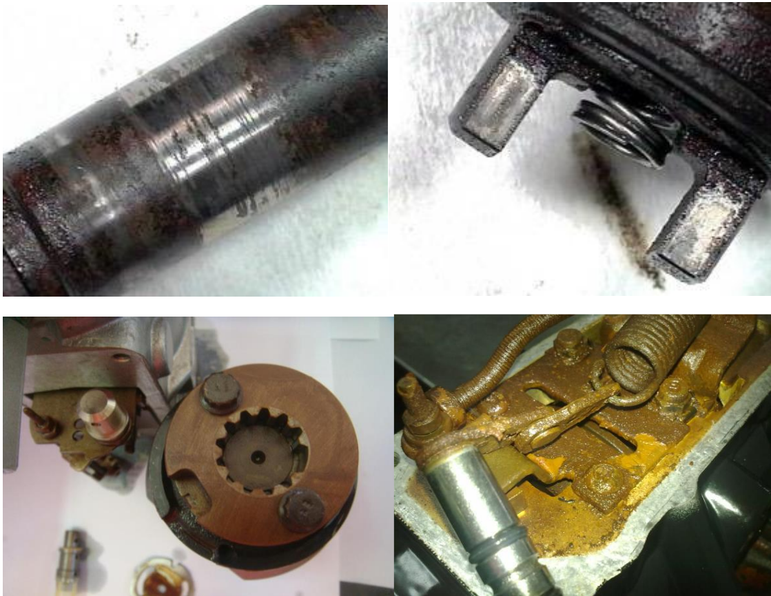
Figura 2 Componentes do sistema de injeção após ação de água livre causando oxidação, desgaste e depósitos de lodo.
