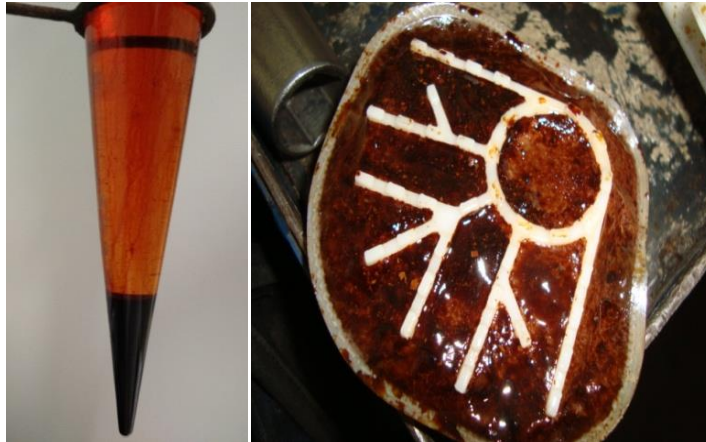
Figura 6 Borrás químicas retiradas de fundo de tanque veicular e presente na superfície de elemento filtrante de bomba de baixa pressão.
