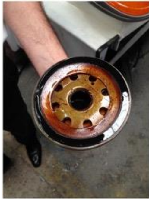
Figura 14 Filtro com formação de “verniz” por depósito e degradação do combustível.
