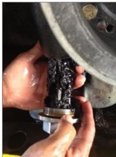
Figura 22 Filtro cesto de bomba de combustível de posto com formação de borras.
