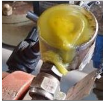
Figura 8 Exemplo de um Óleo diesel com CFPP fora do limite da especificação.
