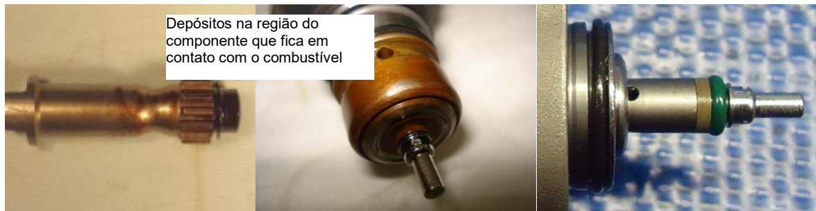
Figura 1 Dois exemplos de componentes com depósitos de produtos de envelhecimento de biodiesel após período de parada do equipamento e de um componente após rodagem com combustível que não causou depósitos.
