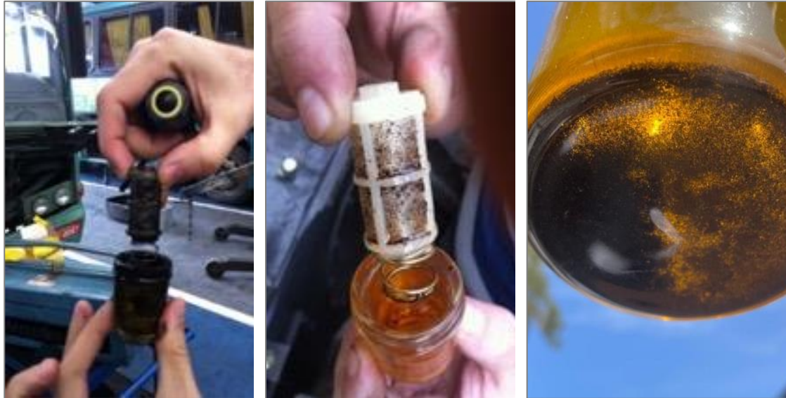
Figura 21 Filtro cesto com Óleo diesel Oxidado e presença de borra e produto drenado do fundo de um tanque com limalha.
