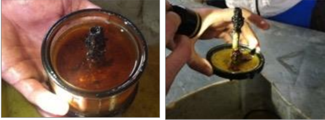
Figura 16 Filtro separador de trator com água e sedimento de origem microbiana e haste impregnada com sedimento de origem microbiana.
