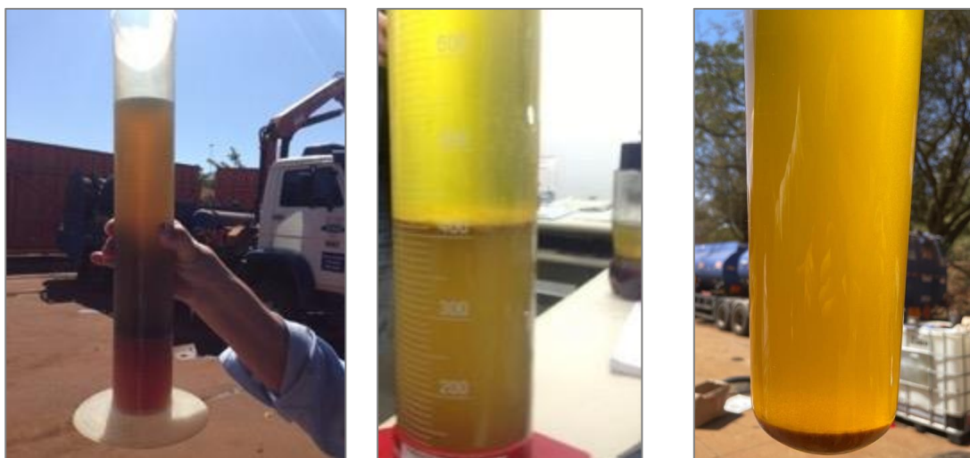
Figura 20 Aspecto de óleo diesel extraído de filtro de caminhão em setor sucroalcooleiro, presença de água emulsificada e biomassa na interface óleo-água.
