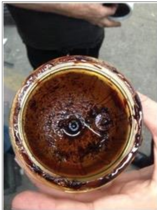
Figura 15 Depósito de sedimentos no fundo de um filtro separador.
