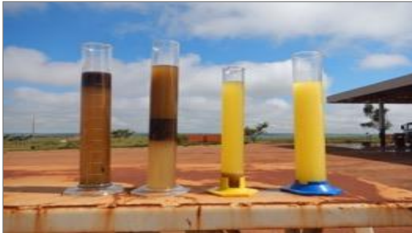
Figura 23 Aspecto de amostras óleo diesel coletadas em tanques que não são drenados corretamente, sendo possível verificar água emulsificada e água livre.
