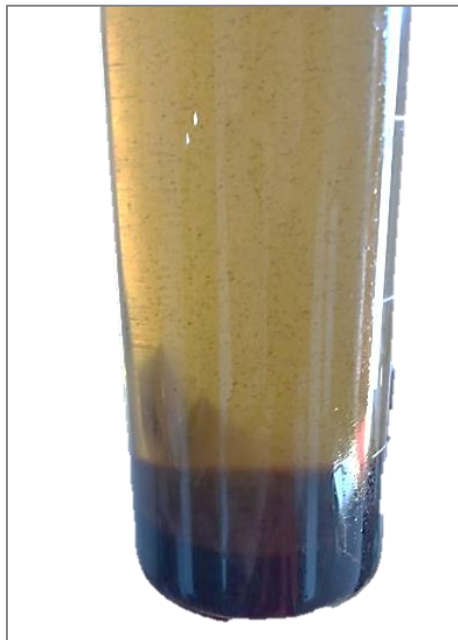
Figura 24 Óleo diesel S10 comum com particulado devido a não drenagem e devido a presença do Biodiesel acelera a produção de borra e oxidação.
