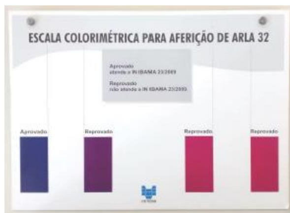
Figura 2 – Exemplo de escala colorimétrica qual pode ser aplicada para aferição do ARLA32
